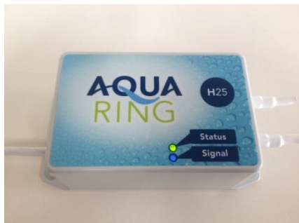
Fig. 9: BLU LUMINOSO: installazione OK
