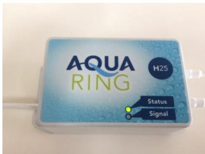
Fig. 10: SPENTO O POCO LUMINOSO : posizionamento NON corretto
