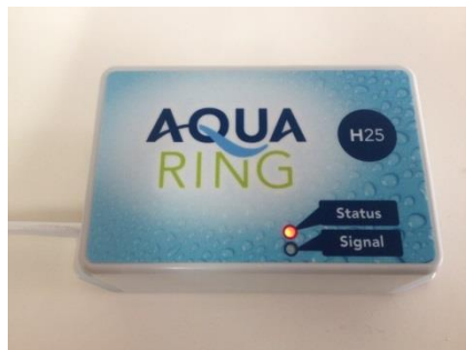
Fig. 8: ROSSO: guasto o mancato collegamento elettrico tra anello e unità di controllo
